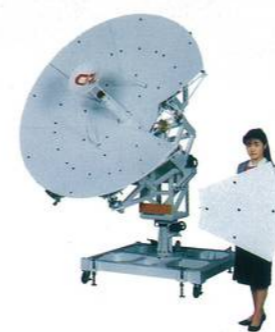
▲宇宙用組立型アンテナ地上試験モデル
