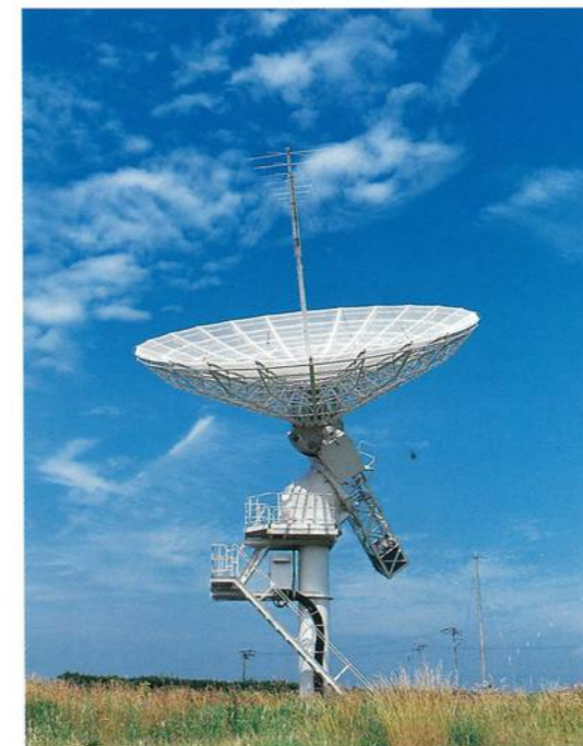
▲70-500 MHz太陽電波ダイナミック・スペクトル計用アンテナ Antenna for 70-500 MHz Solar Radio Dynamic Spectrometer
