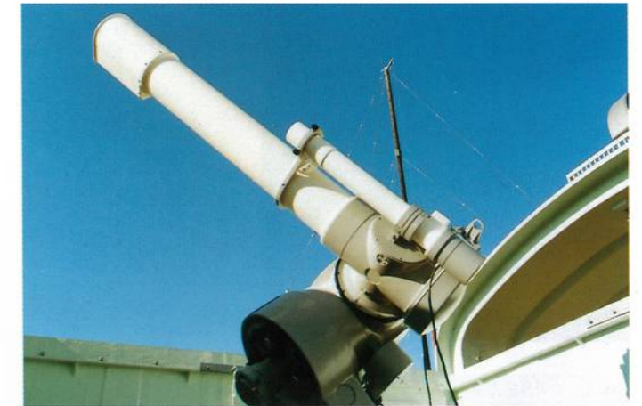
▲太陽面のH \alpha フィルターグラム用望遠鏡▶ Telescope for Solar H-alpha Filtergram
