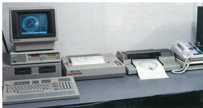
▲32 GHz太陽電波望遠鏡の遠隔制御システム Remote Control System for the 32-GHz Solar Radio Telescope at Kashima
