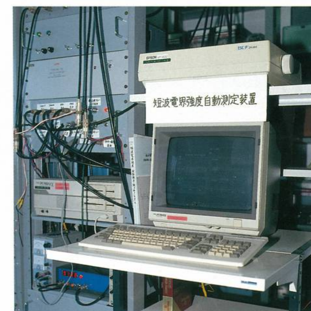
▲短波電界強度リアルタイム表示装置 Real-Time Display of HF Field Strength
