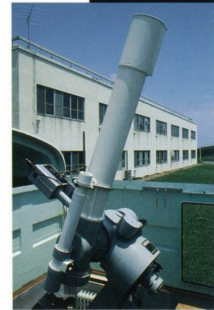
▶ 宇宙空間の乱れの源となる太陽を精密に観測するため、最新鋭の望遠鏡を設置し観測を行っています。
