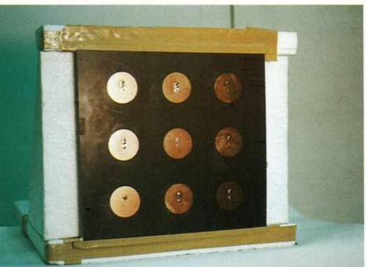
▲マイクロ波電力伝送の受電用レクテナ。
