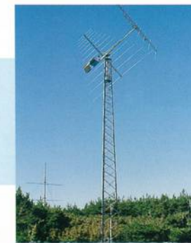
HiRAS-1 (25-70MHz) 直交13素子ログペリアンテナ Crossed 13-element log-periodic antenna
