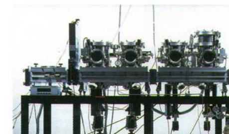
ミリ波回路金属薄膜成膜用スパッター装置 Metal thin-film sputtering system for millimeter-wave circuit
