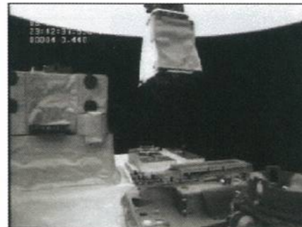
技術試験衛星VII型での軌道上実験の様子 Downlink image of antenna assembling experiment on the ETS-VII
