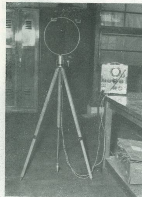
写真 28 短波標準磁界発生機 (電界強度測定器の校正用)
