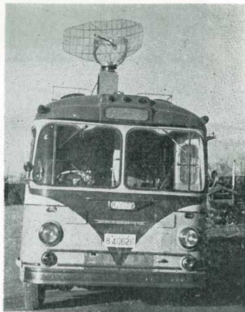
測定車に装備したマイクロ波受信アンテナの外観 (300MC/S)
