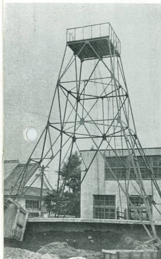
船舶用無線機 (救命艇用無線機等) の衝撃試験に使用する落下試験塔
