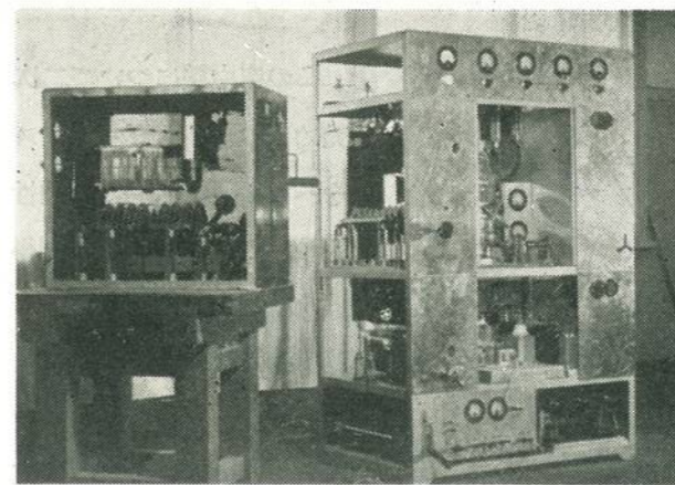
写真4 試作中波インパルス送信機 出力10kW 周波数555kc~790kc 830kc~1585kc インパルス巾100μs, 150μs
