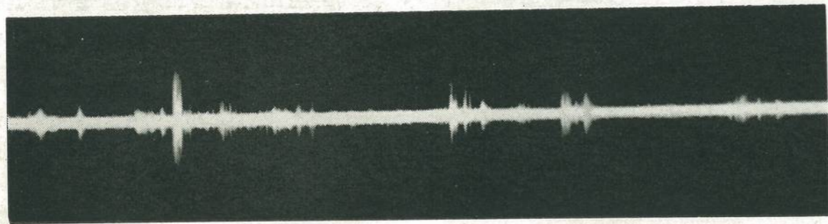
空電雑音波形 周波数 3.5 Mc 7 月 29 日 1955 年 於大平測定所
