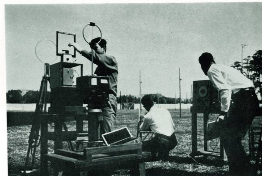
電界強度測定器の性能試験
