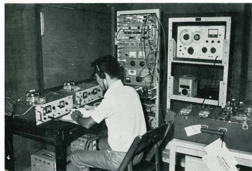
緊急自動受信機の測定試験
