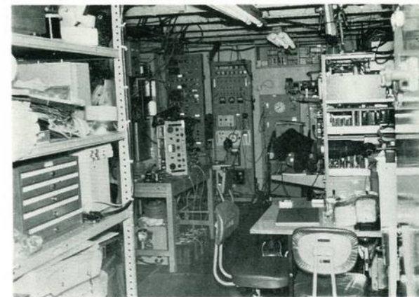
電離層観測装置
