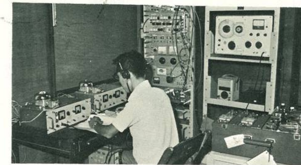
警急自動受信機の測定試験
