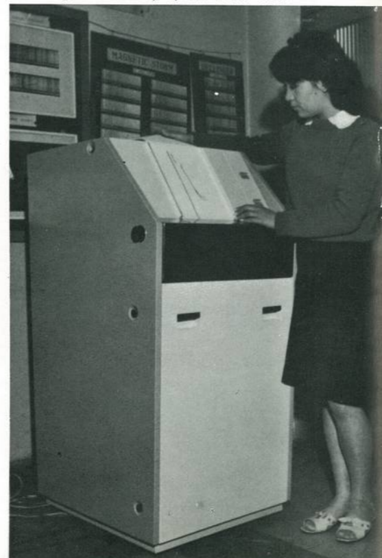
イオノファックス Ionofax (光学ファイバーを利用した電子写真による電離層記録装置) Ionogram Printer by Optical Fiber Tube
