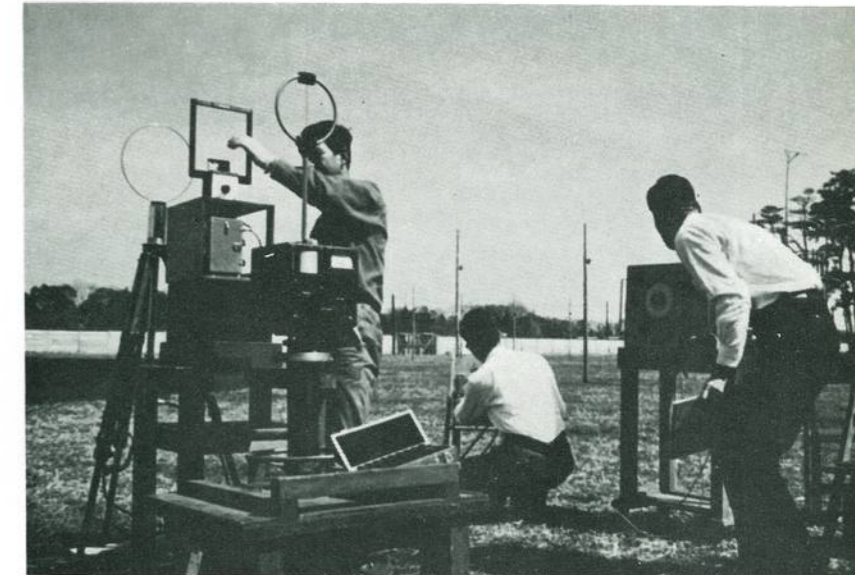
電界強度測定器の性能試験 Testing of Field Strength Meter
