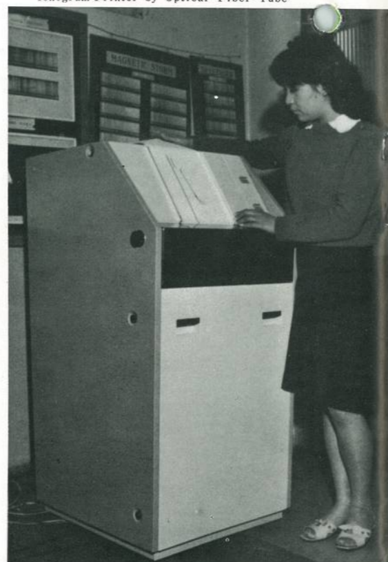
イオノファックス Ionofax (光学ファイバーを利用した電子写真による電離層記録装置) Ionogram Printer by Optical Fiber Tube
