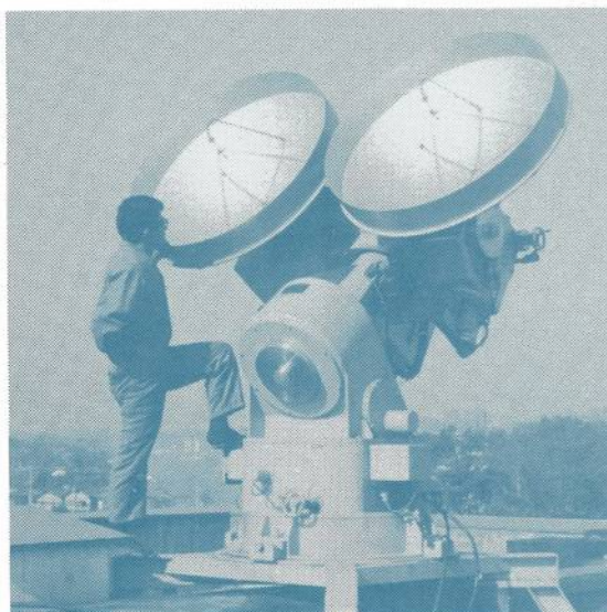
右は35 GHz 帯太陽電波観測用アンテナ
