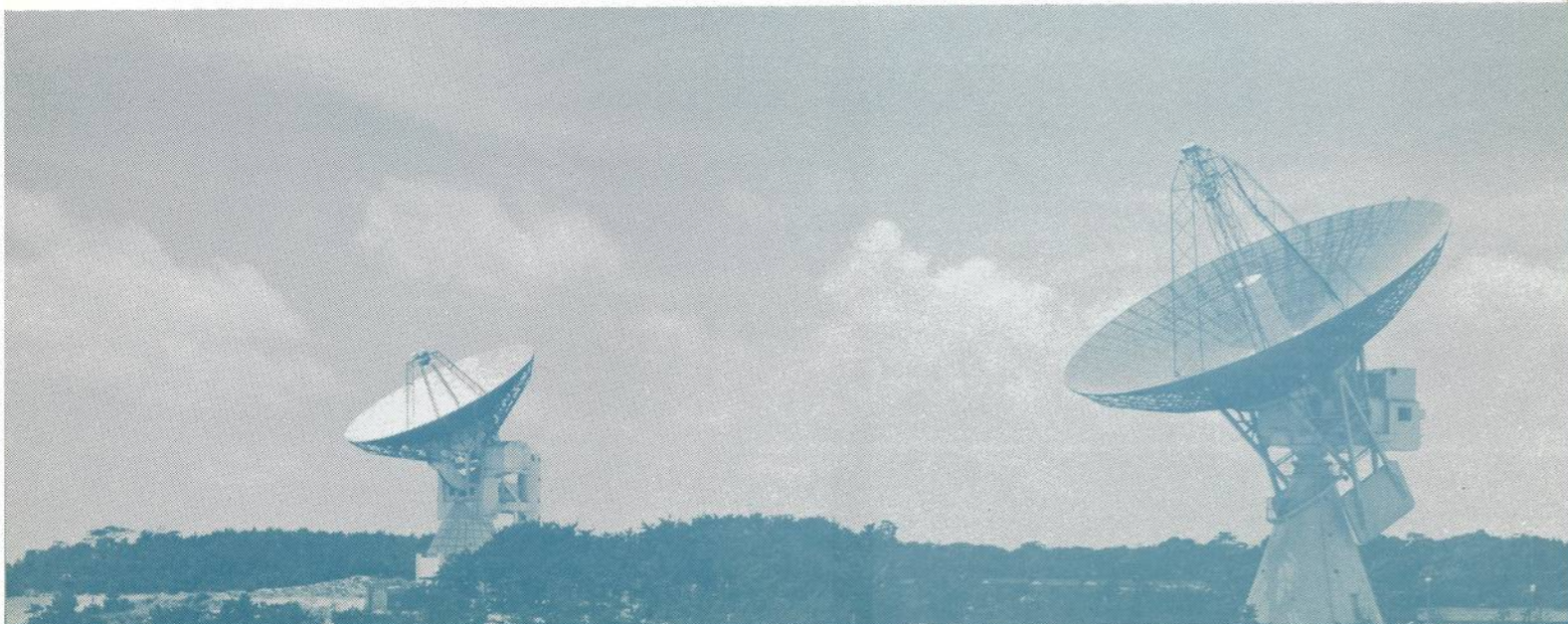
右は35 GHz 帯太陽電波観測用アンテナ
